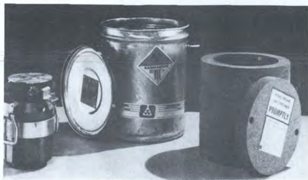
盛装射线照相用 \gamma 源的轻型包装。(来源: Amersham International plc)
