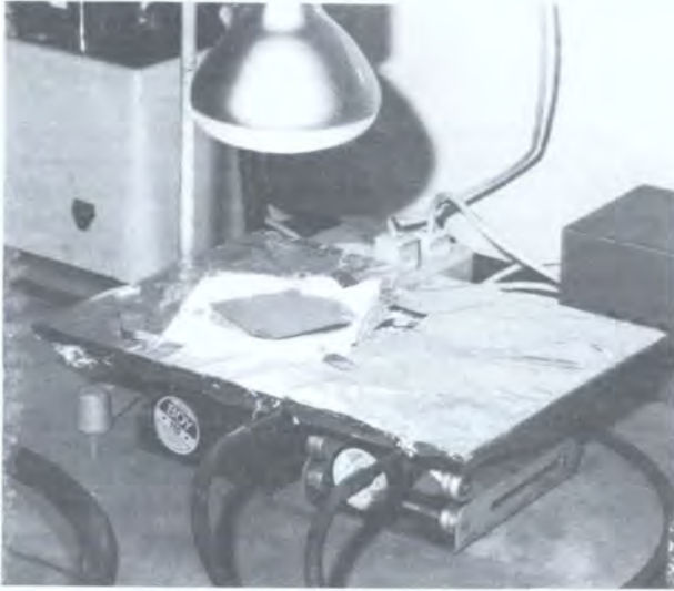
Проводятся исследования по разработке композиций инсектицидов для использования в борьбе с мухой цеце. На фото — экран для привлечения мухи цеце с нанесенным радиоактивно меченным инсектицидом помещен под ультрафиолетовую солнечную лампу «Осрам»; биоанализ экрана, покрытого инсектицидом.
