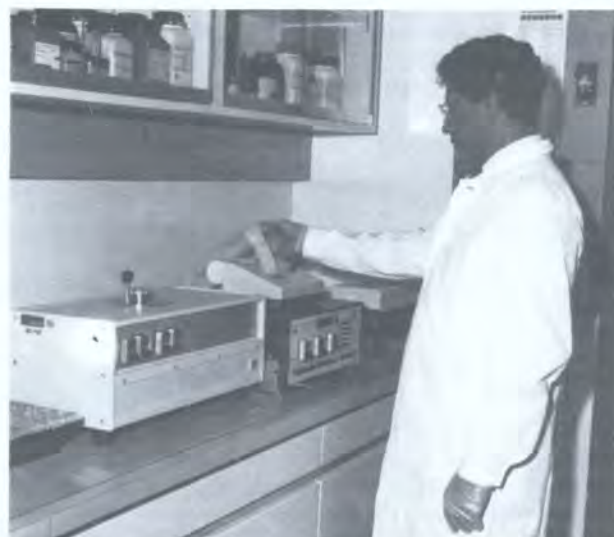
Жидкостный сцинтилляционный счетчик используется для измерения радиоактивности пестицида.
