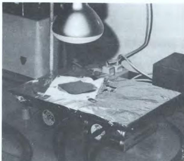
为开发防治采采蝇用的缓释杀虫剂制剂的研究工作正在进行。上图所示为浸渍了放射性标记杀虫剂的采采蝇防治屏障，正在 Osram 紫外线太阳灯下进行辐照；下图所示为正在对浸渍了杀虫剂的防治屏障进行生物鉴定。
