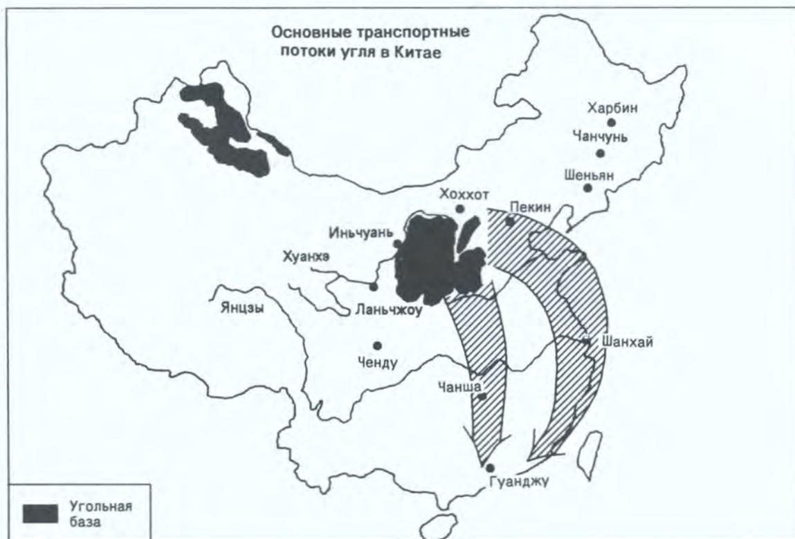
добычи угля или примерно 600 млн. т в год. Уголь перевозится по железной дороге, занимая 40 % общего объема перевозимых по железной дороге грузов, и на судах (одна треть перевозимых на этом виде транспорта грузов) до середины и в низовье реки Чанган и в воды морского побережья. Расстояния, на которые осуществляются перевозки, от угольной базы на севере провинции Шаньси до Шанхая, Ксямена и Гуанджу в прибрежном районе составляют 2000, 2800 и 3300 км, соответственно.
