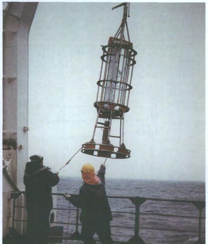
照片:海洋科学家从北极海洋中采取分析用水样。(IAEA-MEL)左图:所有倾倒地瞬时单元释放后第一个6年海水中铯-137浓度预测图。这类预测用于确认潜在受照射人群(Ingo Harms/IAEA-MEL)
