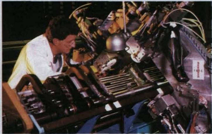
*Un technicien inspecte la structure d'un assemblage combustible. L'intégrité des assemblages combustibles soumis à diverses conditions peut être modélisée grâce à des codes machine complexes. Photo: Framatome*
