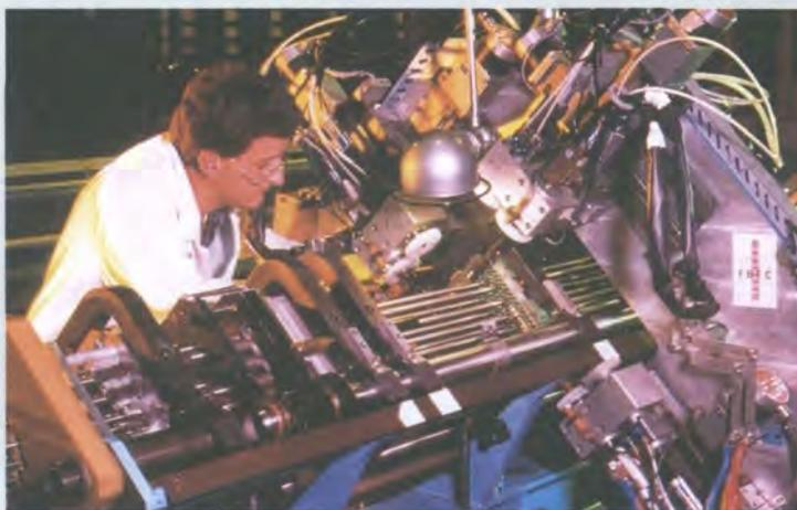
*Специалист проверяет целостность структуры топливной сборки. Целостность топливных сборок в различных условиях может быть смоделирована с помощью сложных компьютерных программ. Фото: Framatome*
