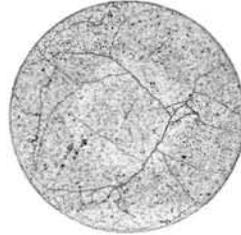
Los estudios han demostrado que con grados elevados de quemado, la estructura del combustible se modifica, según se aprecia en estas vistas ampliadas con un microscopio electrónico. Se forma una capa periférica caracterizada por la presencia de partículas ultrafinas, una gran porosidad entre el 10% y el 20%, y el contenido de plutonio. El círculo de la izquierda muestra una vista más detallada de la estructura normal del combustible.
