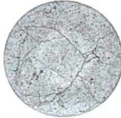
Des études ont montré qu'à des taux de combustion élevés la structure du combustible est modifiée comme l'indiquent ces vues fortement grossies à l'aide d'un microscope électronique. Il se forme une couche périphérique caractérisée par des grains ultrafins, une forte porosité (comprise entre 10 et 20 %) et la présence de plutonium. Le cercle ci-contre est une vue rapprochée de la structure normale du combustible.
