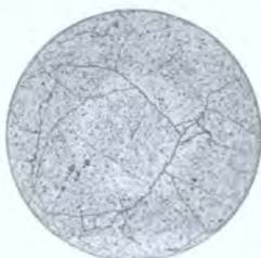
研究已表明,在高燃耗水平下,燃料结构发生改变,如这两幅电子显微镜高倍放大图所示。有一外围边缘层形成,其特点是含超细晶粒,有 10%—20% 高孔隙度,并且含氦。左边圆圈为正常燃料结构的近视图。
