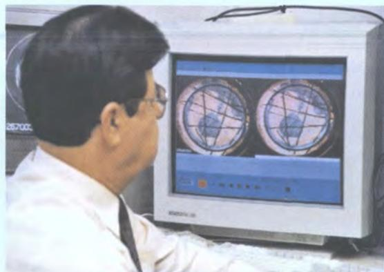
正在机构总部检查 IAEA 保障封记,以确保没有擅自接触或扰乱核材料或保障设备。
