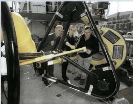
*Foto: En agosto de 2000, el Instituto de Protección Radiológica de Irlanda, en colaboración con el Servicio de Medio Ambiente y Patrimonio de Irlanda del Norte y el OIEA, desplegó una boya experimental en el mar de Irlanda, equipada con un detector de radiaciones capaz de medir continuamente la contaminación radiactiva en el agua de mar. (Cortesía: OIEA-MEL)*
