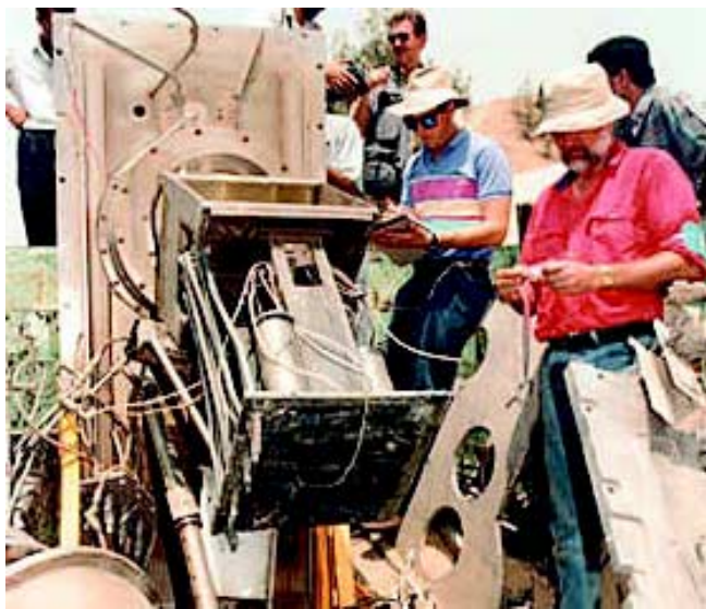
视察员检查从一幢被炸伊拉克建筑物中搜出来的电磁同位素分离 (EMIS) 设备残骸。
