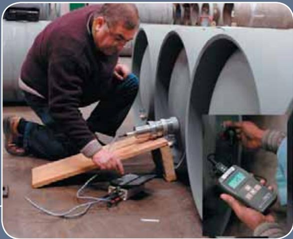
**5** Comprobar el cilindro es una cosa, y comprobar su contenido, otra. Los inspectores disponen de instrumentos muy perfeccionados, como detectores de germanio y yoduro sódico – en la foto – para detectar los niveles de enriquecimiento, pues casi todo el material enriquecido emite rayos gamma. Estos instrumentos del comercio ayudan a los inspectores a verificar la exactitud de los registros de las fábricas.
