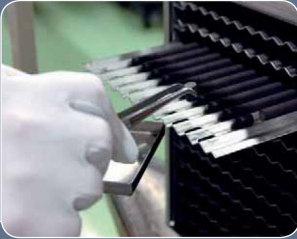
**10** Las cajas de metal contienen bandejas en las que se depositan las pastillas de combustible acabadas. Cada una de éstas, poco más grande que el borrador de un lápiz, contiene dióxido de uranio enriquecido que se utilizará en centrales nucleares.
