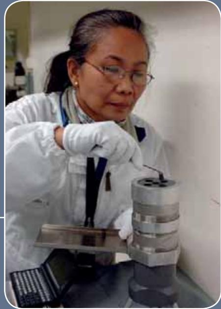
**11** Una inspectora verifica el enriquecimiento de la pastilla por medio de un instrumento denominado “analizador de mini-multicanales”, conectado a una computadora que cabe en la palma de una mano.
