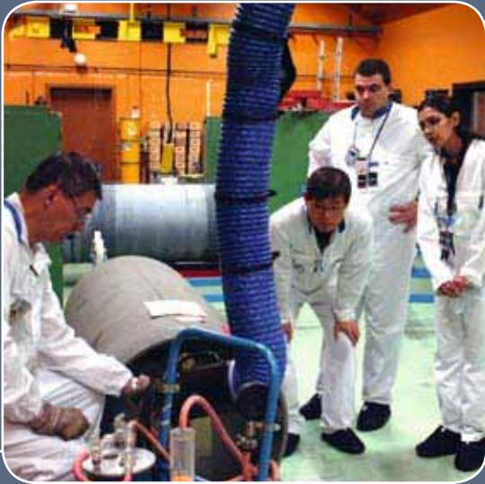
7 视察员的另一项工作是核实铀转化过程中的浓缩水平。图为视察员正在观察工厂操作员小心地提取UF<sub>6</sub>样品以进行同位素成分分析。
