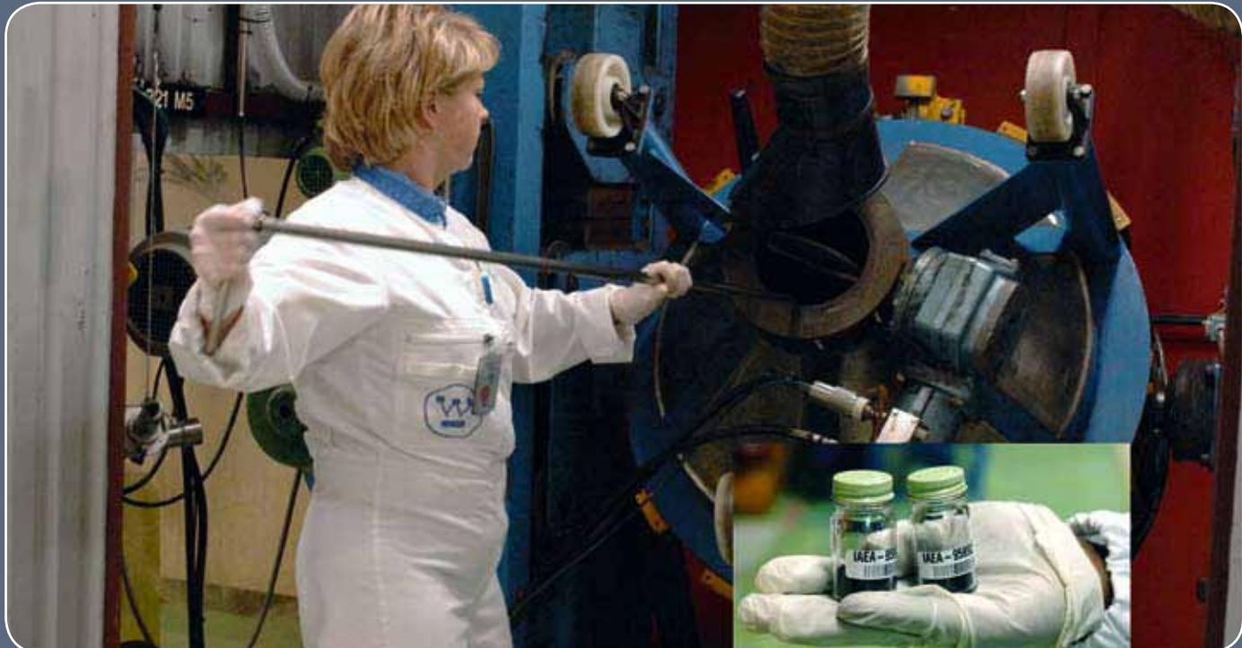
9 设施操作员正在小心地从倾斜的储料器中取样。粉末状的样品被倒进2个小玻璃瓶（小图）。
