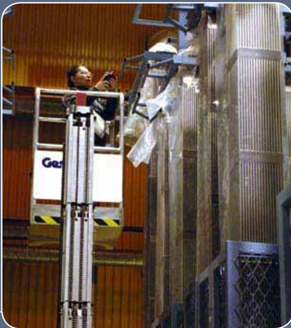
**12** 上到源处有时是接近组件进行关键性测量的唯一途径。此图为起重机将一位视察员升到空中以测量活性长度。
