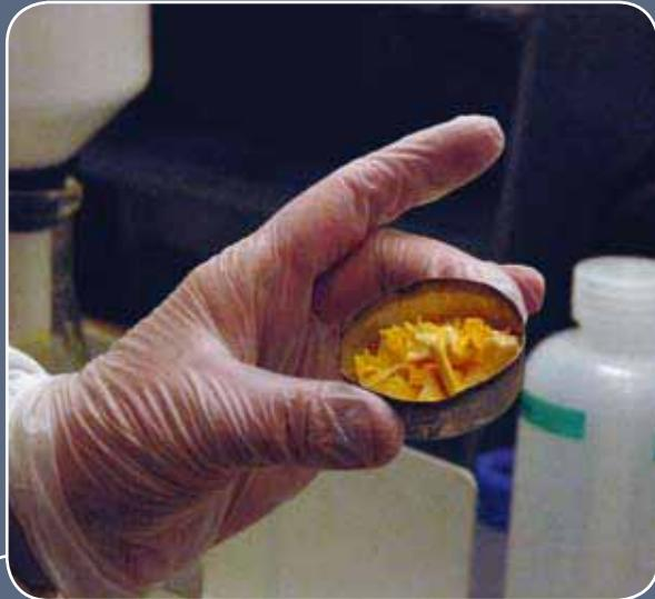
8 UF<sub>6</sub>取样过程最终产生浓缩的二氧化铀，即“黄饼”。样品被置于炉内烘烤3小时以模拟铀转化工艺。然后，样品被送往国际原子能机构设在奥地利塞伯斯多夫的保障分析实验室进行浓缩水平分析。
