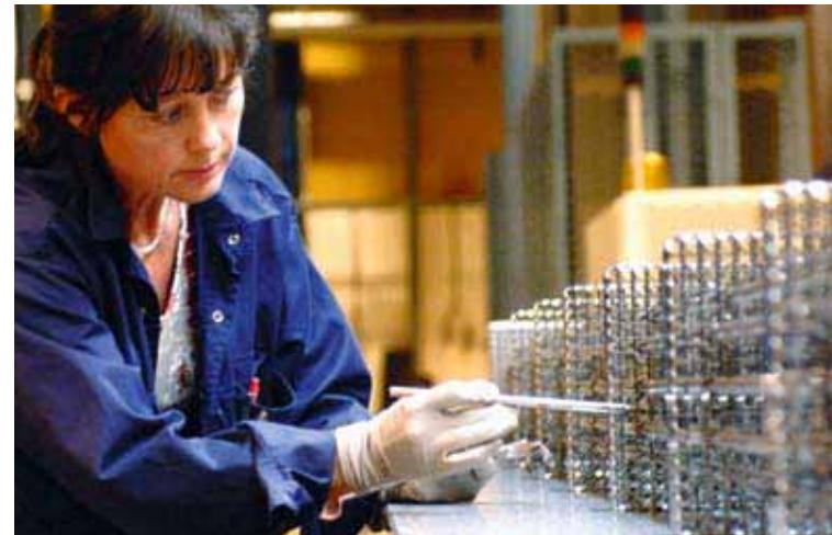
一些旨在解决核燃料循环问题的方案倡议再一次被提出。图中，技术员正在燃料组件的一个最后阶段检查核燃料棒。照片来源：国际原子能机构Dean Calma
