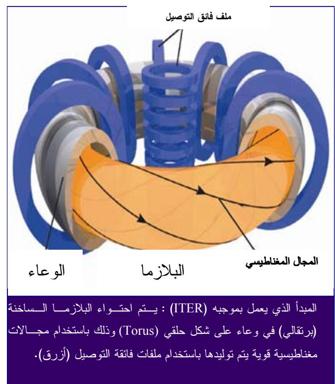
المبدأ الذي يعمل بموجبه (ITER) : يتم احتواء البلازما الساخنة (برتقالي) في وعاء على شكل حلقي (Torus) وذلك باستخدام مجالات مغناطيسية قوية يتم توليدها باستخدام ملفات فائقة التوصيل (أزرق).
