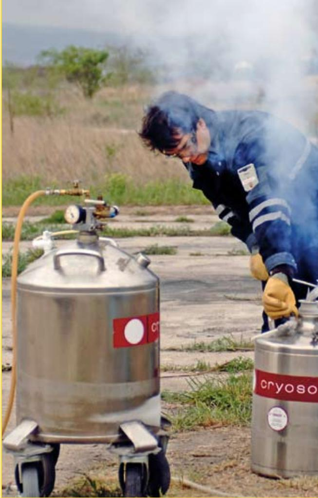
Normalmente se usa nitrógeno líquido para enfriar los cristales de los espectrómetros. Un contenedor con el elemento refrigerante estaba disponible in situ para que los equipos pudieran rellenar sus depósitos.
