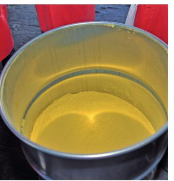
El mineral de uranio se procesa para convertirlo en un concentrado conocido como concentrado de uranio o torta amarilla, que se fabrica en una central a pocos kilómetros de la mina.
