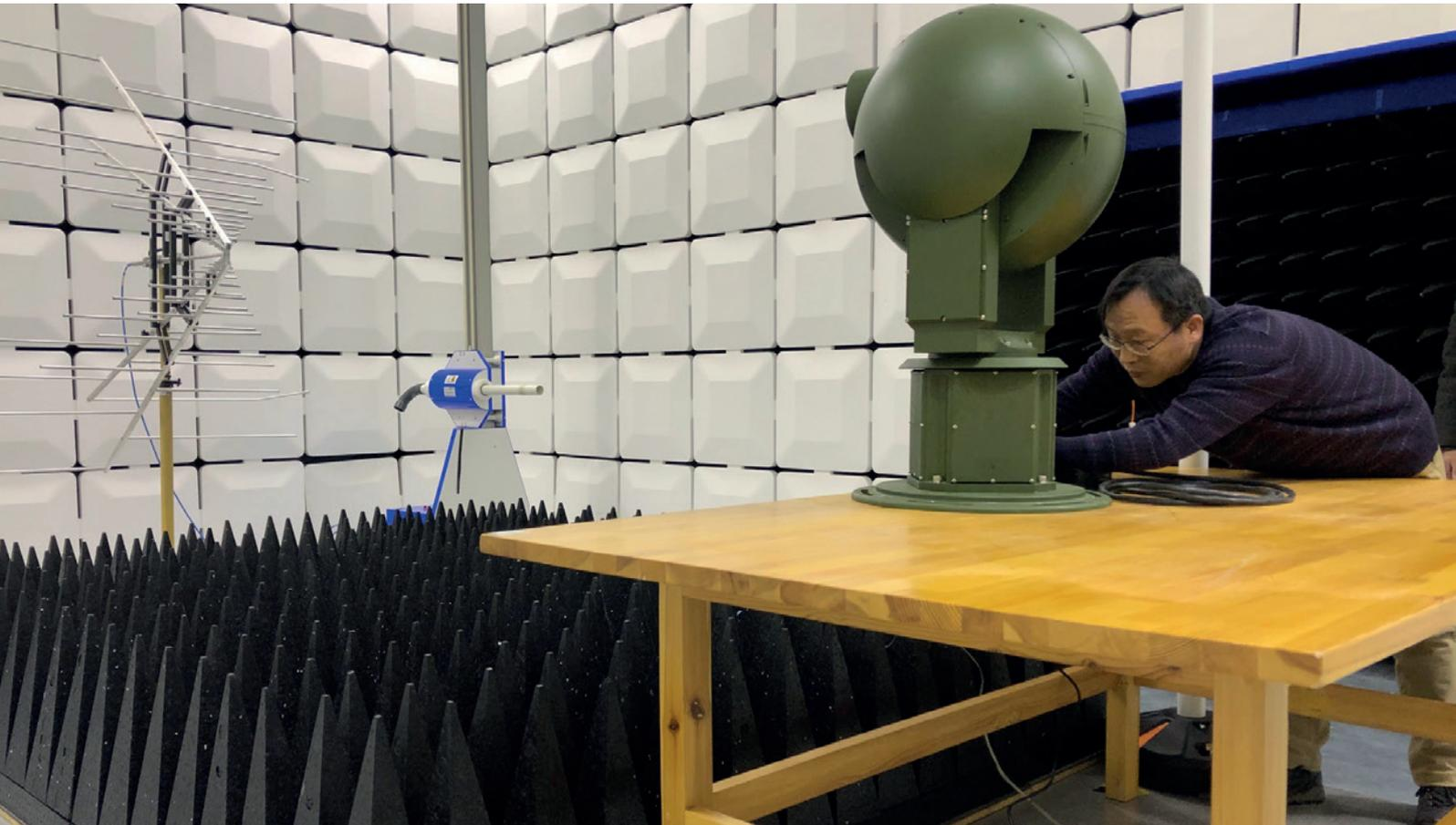
**Sala de simulación en el SNSTC, diseñada para generar y contener ondas electromagnéticas fuertes para poner a prueba equipos de seguridad física nuclear.** (Fotografía: M. Gaspar/OIEA)
