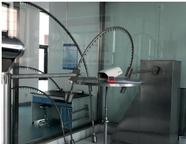
**Utilización de un simulador de lluvia para ensayar la resiliencia de una cámara de vigilancia.** (Fotografía: M. Gaspar/OIEA)
