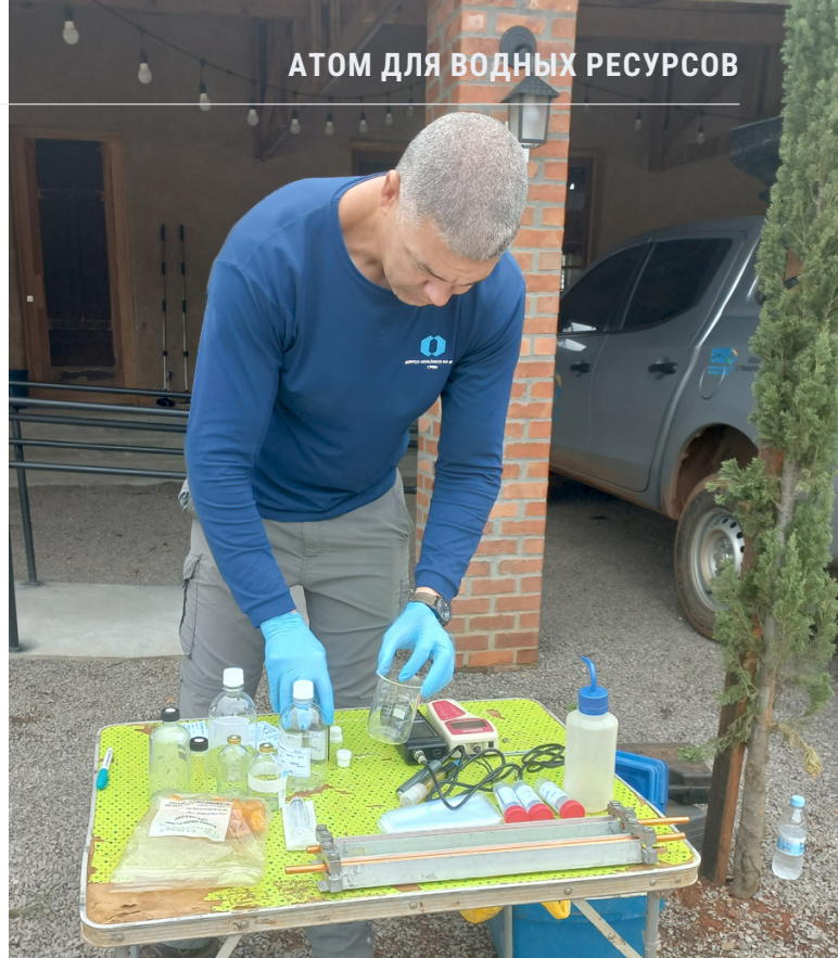
Специалист по гидрогеологии из ГСБ проводит отбор проб воды для изотопного анализа на одном из участков водоносного горизонта Гуарани на юге Бразилии.
