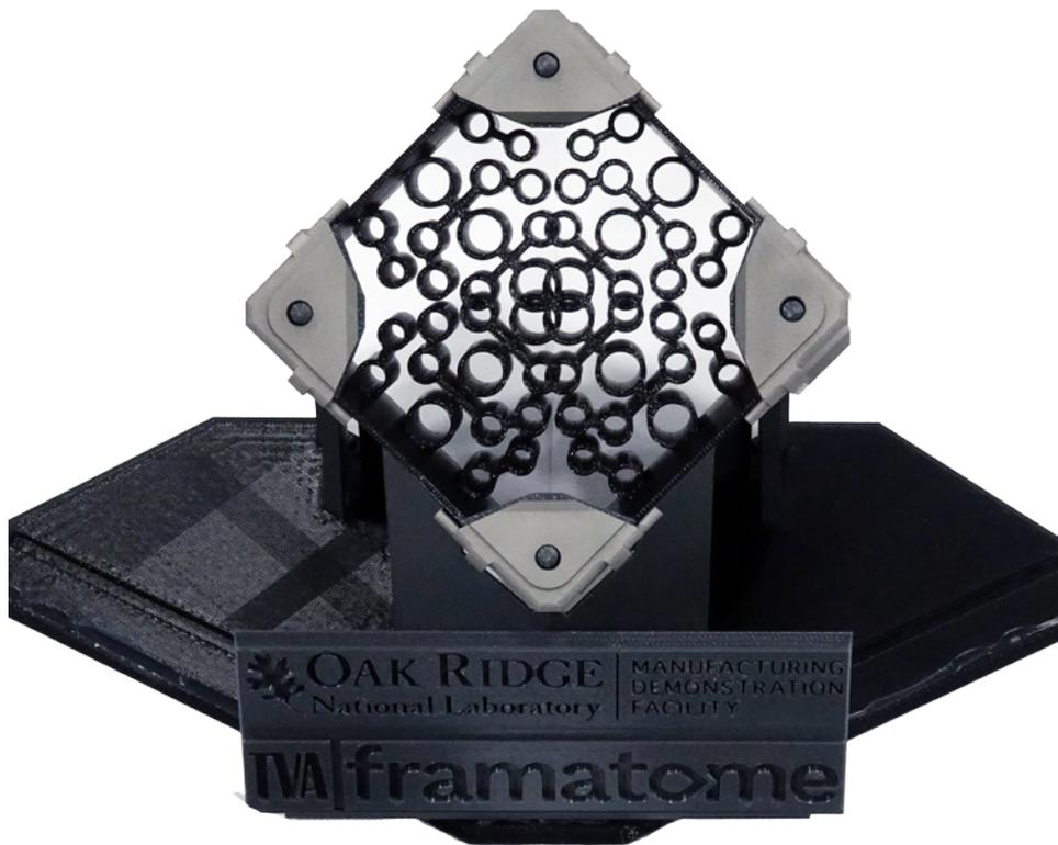
这些燃料组件支架由橡树岭国家实验室与法马通公司和田纳西流域管理局合作制造，是将安装到核电厂的首批3D打印安全相关部件。
