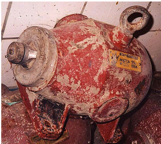
الشكل ٢ - مصدر مشع مهمل (جهاز سيزيوم-١٣٧ لقياس المستوى).
