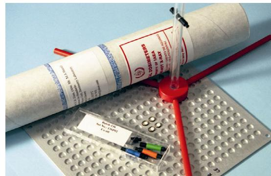
РИС. 2. Служба ТЛД для дозиметрических проверок в радиотерапии.
