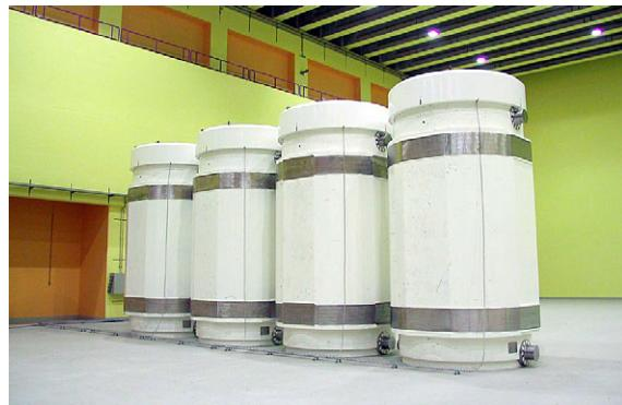
РИС. 2. Контейнеры для промежуточного хранения и транспортировки в хранилище ZWILAG, Швейцария.
