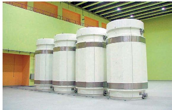
Fig. 2 Almacenamiento provisional y cofres de transporte en la instalación de almacenamiento provisional de ZWILAG, (Suiza).
