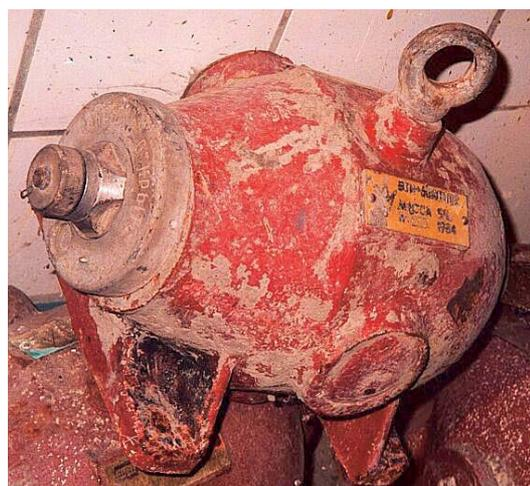
Fig. 2. Fuente radiactiva en desuso (calibrador de nivel con cesio 137).
