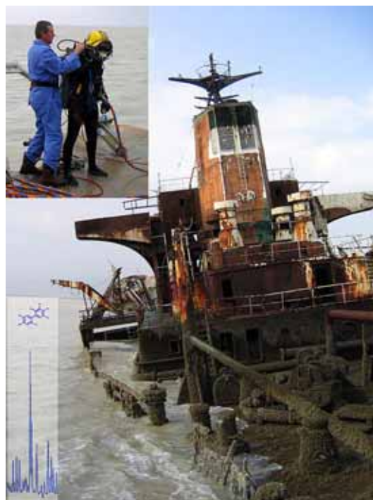
Fig. 2. Échantillonnage en vue de la mesure de la pollution (en médaillon, en haut) et analyse par chromatographie (en médaillon, en bas) de sédiments prélevés près d'une des 35 épaves de navires échoués dans les voies d'eau irakiennes.
