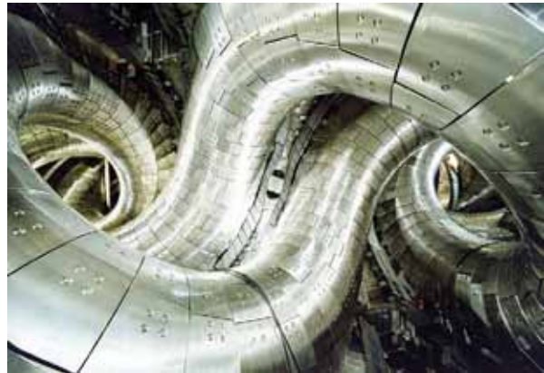
Fig. 2. Vue intérieure de la chambre à vide du stellarator japonais LHD — concept de confinement magnétique toroïdal — montrant l'enroulement hélicoïdal couvert du systèmes de bobines. Le plasma de fusion est confiné par les bobines à l'intérieur de la chambre à vide.
