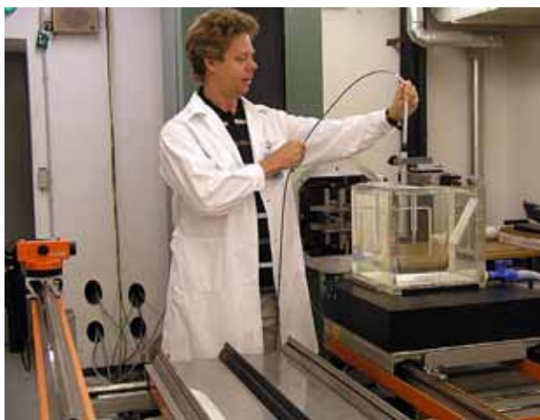
Fig. 3. En radiothérapie, la précision des mesures de doses est vitale. Ici, un physicien des laboratoires de l'Agence à Seibersdorf étalonne un dosimètre qui sera utilisé dans un État Membre.
