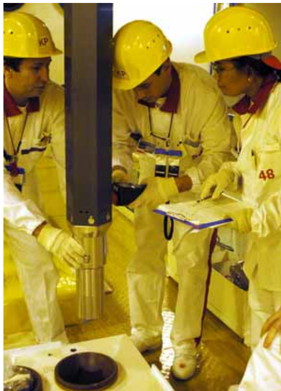
Fig. 1. Des inspecteurs des garanties nucléaires vérifient la longueur active d'un assemblage combustible neuf à l'aide d'un système de mesure gamma à la centrale nucléaire de Mochovce (Slovaquie) au cours d'une activité de formation.
