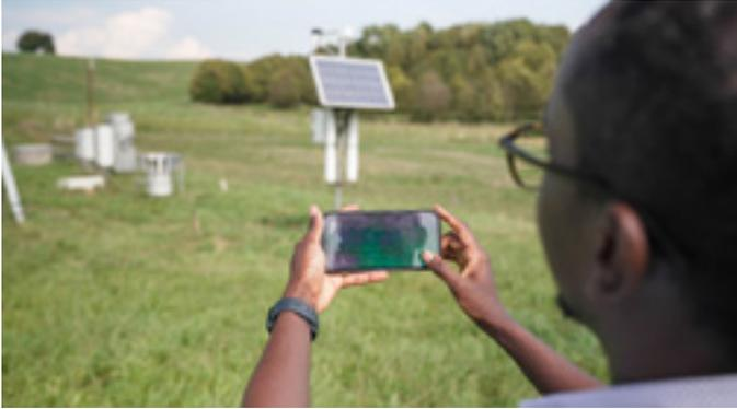
Un agricultor monitoriza los niveles de agua del suelo con una sonda de neutrones de rayos cósmicos que recopila datos sobre la humedad del suelo en tiempo real y los envía al teléfono inteligente, en primer plano. (Fotografía: M. Casling/OIEA)
