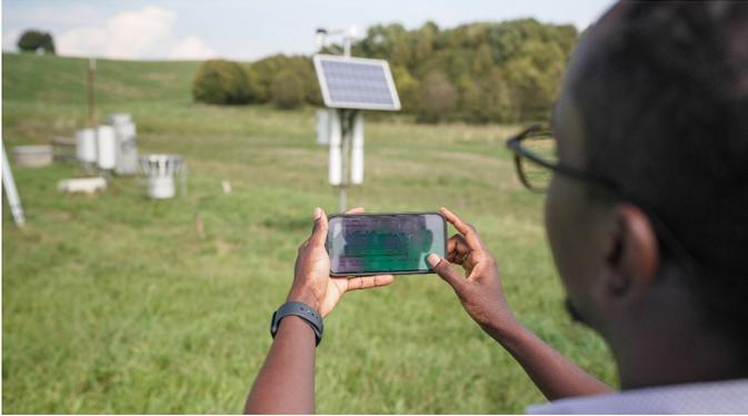
Un agriculteur utilise un humidimètre à neutrons de rayons cosmiques pour surveiller les niveaux d'eau dans le sol. Les données sur l'humidité recueillies par l'appareil s'affichent sur le smartphone au premier plan. (Photo : M. Casling/AIEA)
