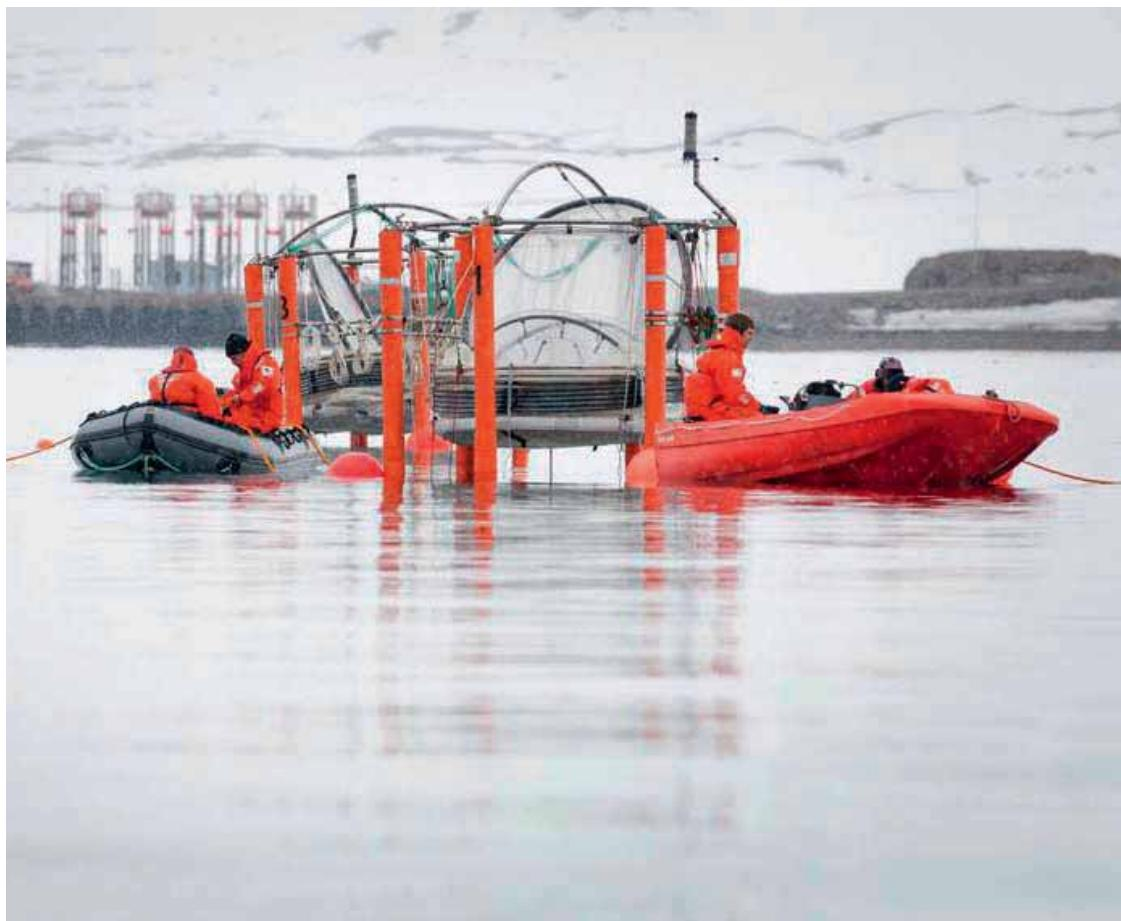
可以在称作中型实验生态系的浮动或海底张拉结构中实施放射性示踪剂研究。这种宝贵的实验工具使得能够在结合实验室和现场工作两方面优势的受控条件下研究自然环境。（照片由尼克•库宾提供）
