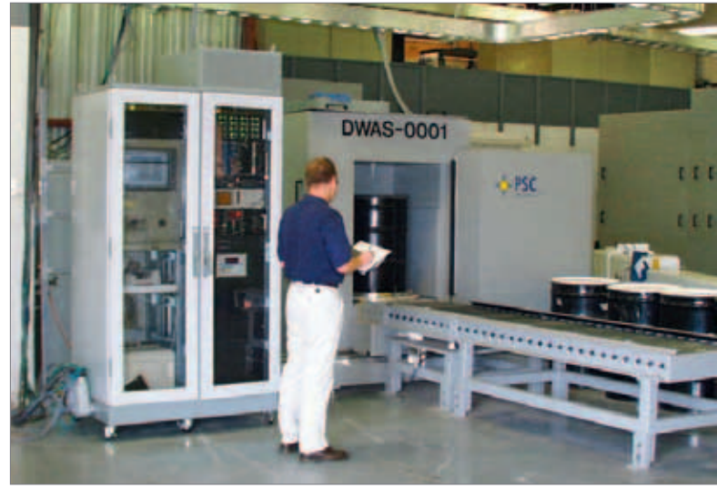
نظام اضمحلال النيوترونات الخاملة والنشطة التفاضلي (نظام PANDDA™ )، نظام رصد أسطواني للقياس العالي الاستبانة لطيف أشعة غاما (مصدر الصورة: شركة Pajarito Scientific Corporation، الولايات المتحدة الأمريكية)
