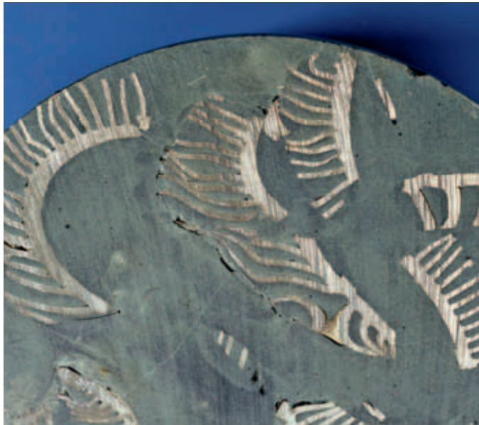
تغليف كسوة وقود ماغنوكس بالإسمنت في شركة Sellafield (مصدر الصورة: شركة Sellafield المحدودة، المملكة المتحدة)
