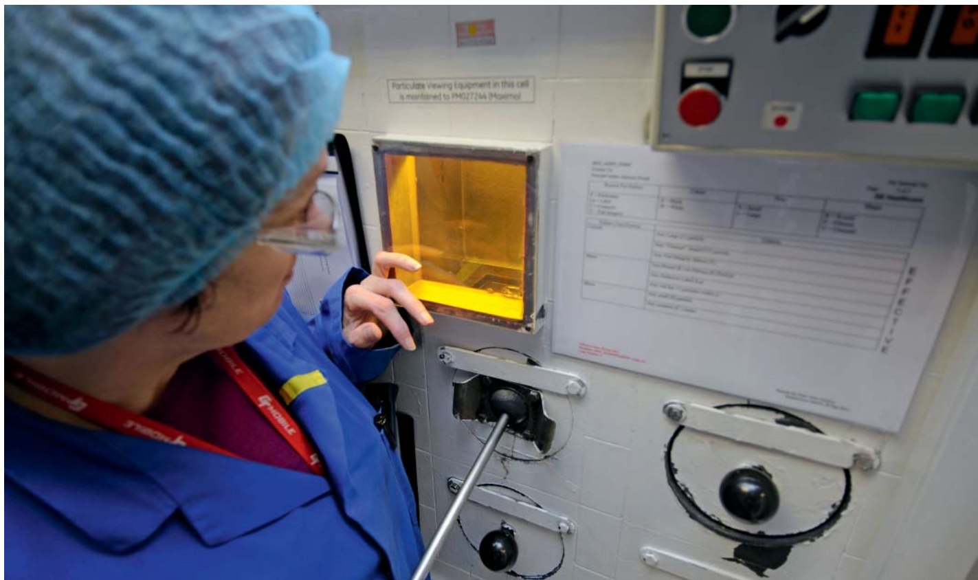
Визуальный контроль внутреннего объема защищенного контейнера во время подготовки радиофармпрепаратов к расфасовке в стеклянные флаконы. (Фото: Д. Кальма/МАГАТЭ)
