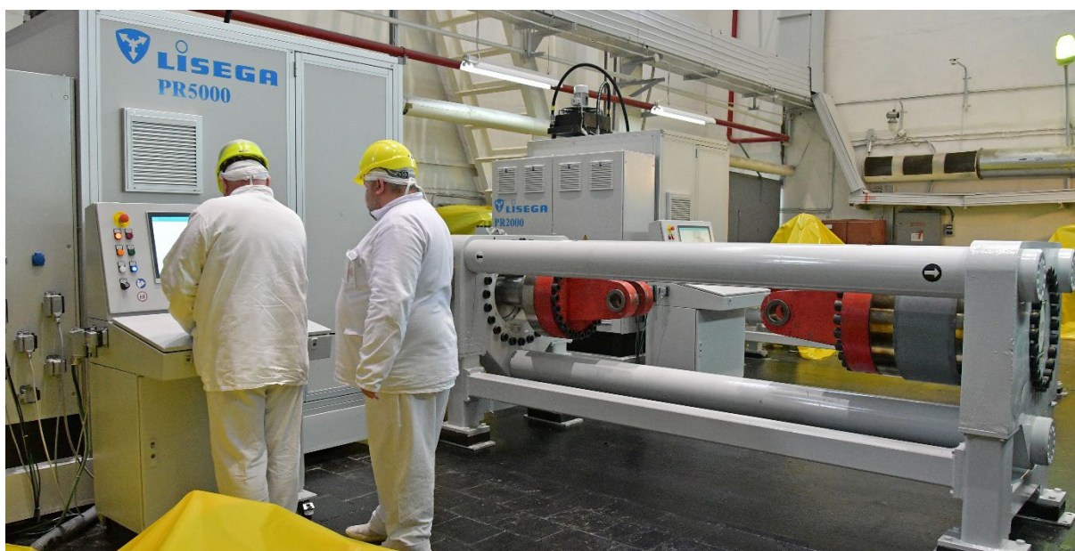
Сотрудники РАЭС выполняют тестирование стенда Р-500 для статических испытаний, 24 апреля 2025 года. (Фото: РАЭС)
