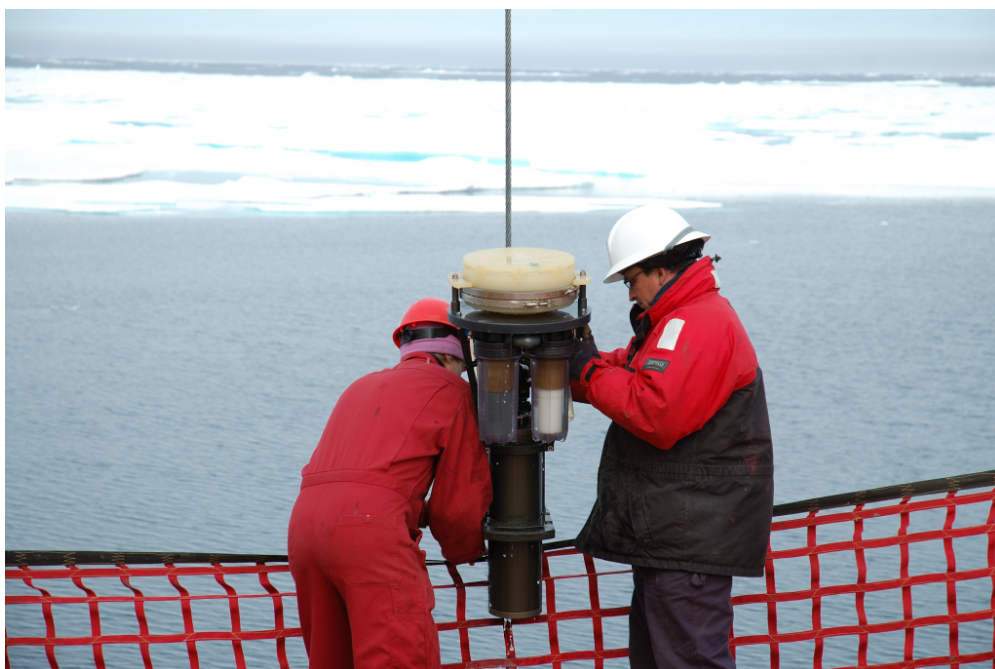
Fig. G-2. Utilización de una bomba de gran volumen in situ a fin de recoger partículas que se utilizan para medir la concentración de radionucleidos en aguas árticas.
