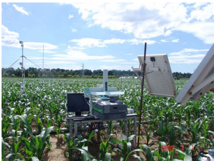
Fig. E-5. Medición de la evaporación del suelo y la transpiración de las plantas en un campo de maíz mediante el uso de técnicas convencionales e isotópicas (cortesía del Prof. Xurong Mei).
