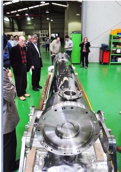
الشكل ٣- مشاركون في المشروع البحثي المنسق بشأن تقييم أداء الوقود المستهلك والبحوث المتعلقة به يفحصون معدات اختبار عملية محاكاة الخزن الجاف (DrySim6)، في المعهد الكوري لبحوث الطاقة الذرية (الصورة مقدمة من شركة فوجي "VUJE").
