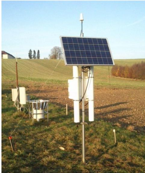
الشكل ٢- نظام لقياس رطوبة التربة بالأشعة الكونية في Petzenkirchen، النمسا.
