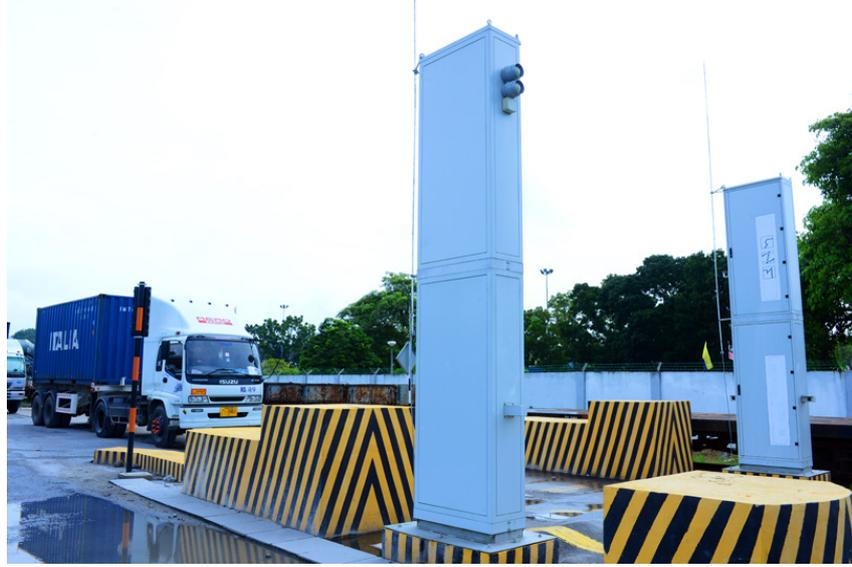
الشكل ١ - جهاز رصد إشعاعي بوابي عند الحدود بين تايلند وماليزيا. يكشف هذا الجهاز عن الإشعاعات في الوقت الحقيقي دون تعطيل عمليات الاستيراد- التصدير الاعتيادية.
