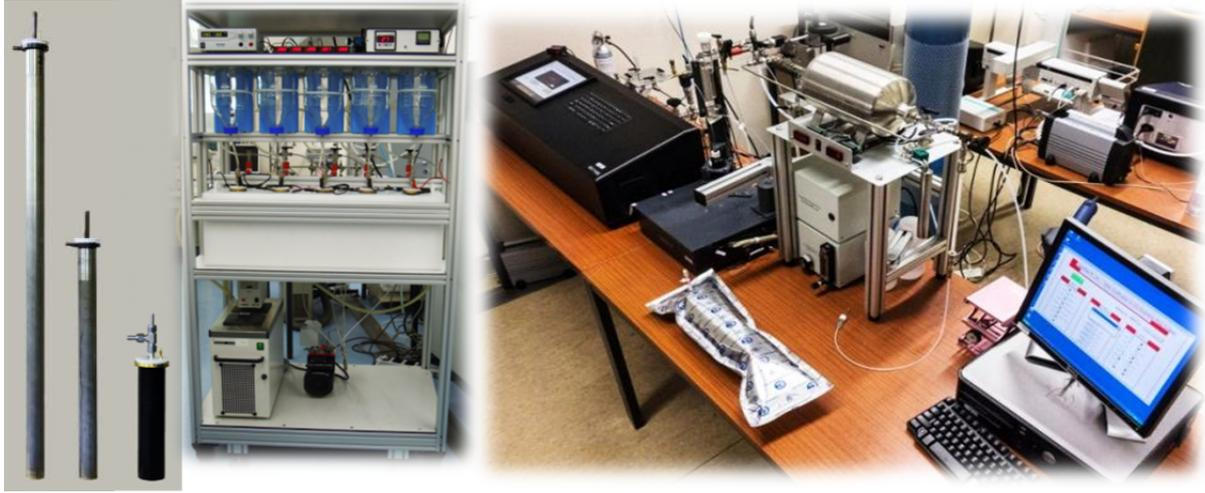
الشكل ٢ - استُكمل في عام ٢٠١٣ وضع واختبار نظام عالي الأداء للإثراء الإلكتروني للتريتيوم (اليسار والوسط) من أجل تحديد عمر المياه الجوفية. جهاز للقياس الطيفي لامتناهات الليزر (اليمين) يجري اختباره في مختبر الهيدرولوجيا النظرية التابع للوكالة من أجل تحليل محتوى الكربون-١٣ من الكربون المذاب في العينات المائية.
