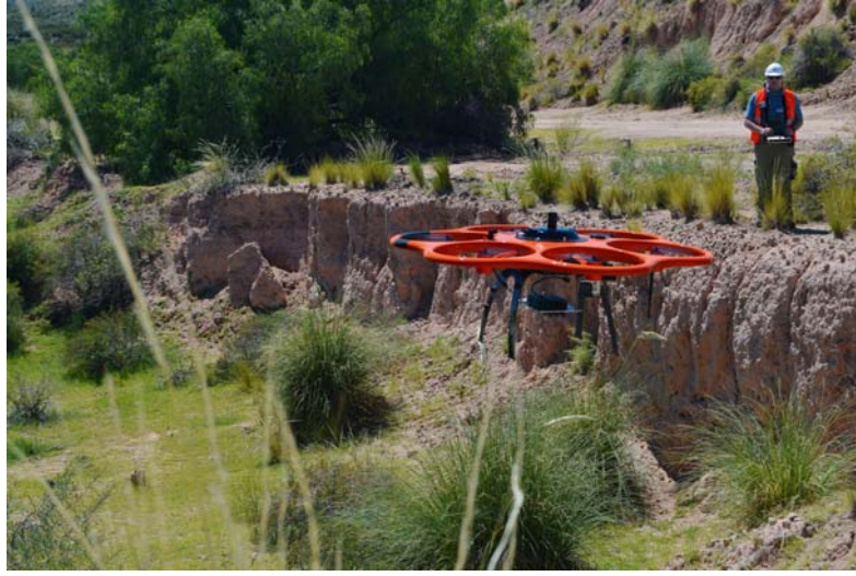
الشكل ٢ - كجزء من نظام المركبة الجوية بلا طيار للرسم السريع للخرائط البيئية التابع للوكالة، تستخدم طائرات بدون طيار تُركَّب عليها أجهزة استشعار وكاميرات لجمع البيانات عن بعد تحضيراً للاستصلاح البيئي.
