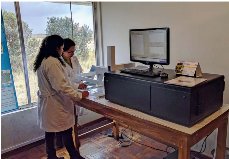
الشكل ١ - كجزء من مشروع التعاون التقني، نظراء من بوليفيا يجمعون عينات من المياه الجوفية في الميدان (الصورة العلوية)، ثم تحلل تلك العينات لقياس نسبة النظائر باستخدام محلل يعمل بالليزر قَدِّمته الوكالة (الصورة السفلى).
