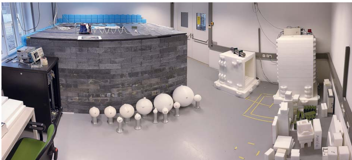
À l'issue de la mise en service complète de son installation de neutronique, l'Agence s'est servie des structures blindées abritant les générateurs de neutrons deutérium-deutérium (à droite) et deutérium-tritium (à gauche) pour dispenser son premier cours pratique de deux semaines sur la neutronique et ses applications.
