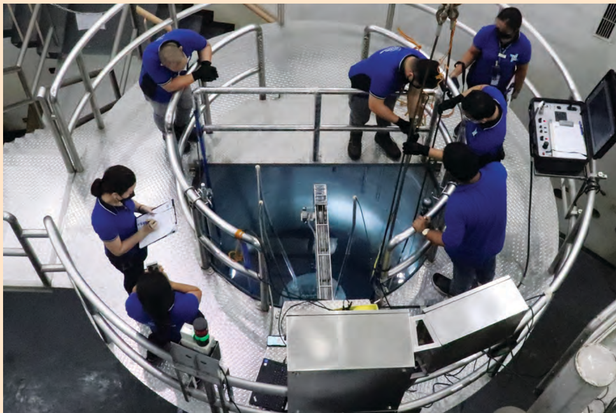
Идет загрузка топливного стержня в активную зону филиппинской подкритической сборки в учебных и исследовательских целях (SATER) на Филиппинах. (Фотография предоставлена Филиппинским институтом ядерных исследований (ФИЯИ))
