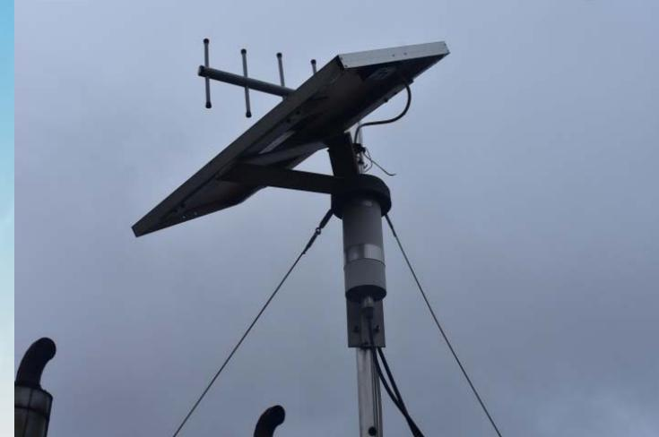
Sensor autónomo de monitorización radiológica "Rados"
