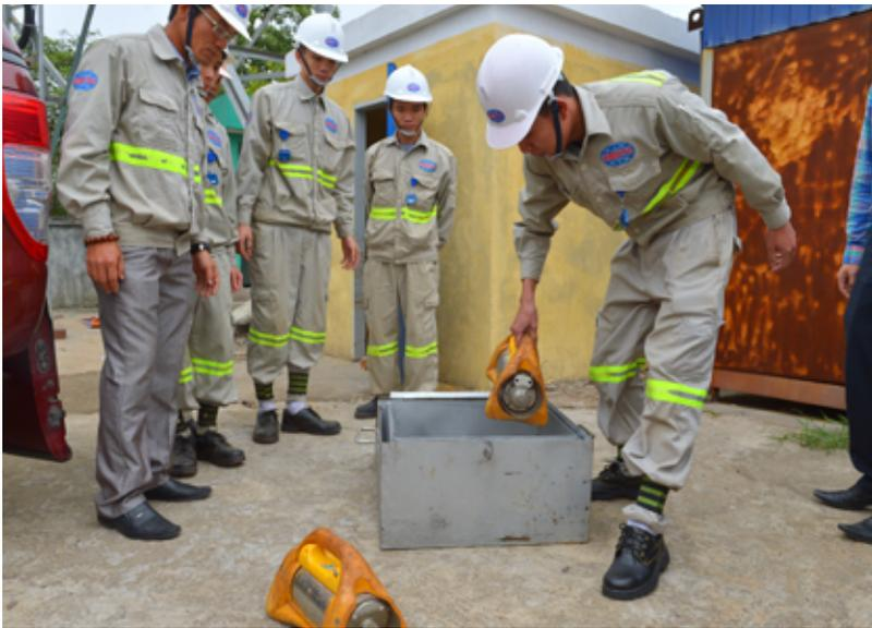
**7** 为了测试放射源定位跟踪系统，韩国同事与越南同事一起进行现场测试，以验证跟踪系统在各种操作条件下的功能。对系统进行测试，可确保许可证持有者和监管人员清楚其任务和责任，并确保在系统部署时提供额外一层安保。
