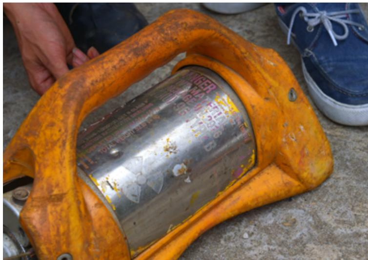
**2** 以类似于使用X射线检查骨裂的方式，使用工业射线照相装置检查工业部件中的裂纹或缺陷。这些装置包含放射源并且是便携式的，这使得它们容易丢失或被盗。每年都有放射源丢失或被盗情况报告给原子能机构。
