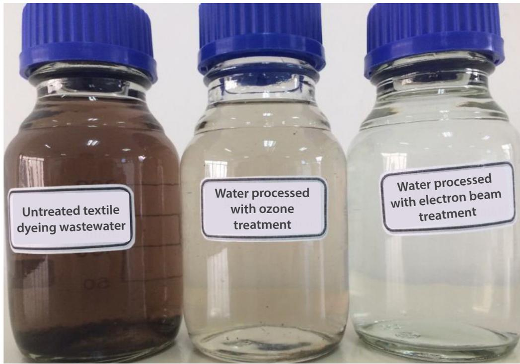
**Comparaison d'un échantillon d'eaux usées traité grâce à la technologie des faisceaux d'électrons et d'un échantillon traité selon une autre méthode avec un échantillon non traité.**
