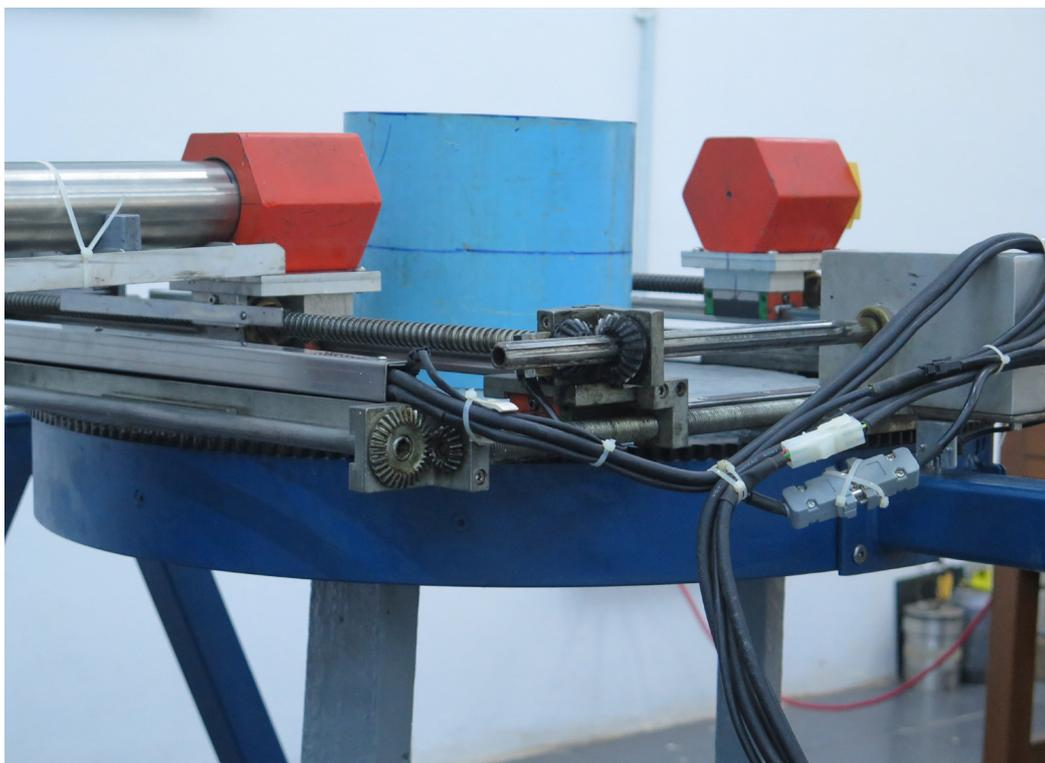
La source radioactive de cet appareil d'END (à gauche) émet un rayonnement. Les particules radioactives réagissent au contact de la substance dans le tuyau bleu clair (au milieu). Le détecteur, situé de l'autre côté du tuyau, effectue une mesure du rayonnement, qui donne des informations sur la qualité et la quantité de matériau circulant dans le tuyau.
