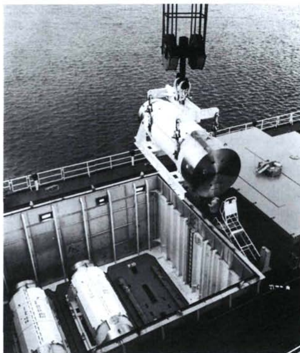
Emballage de grande dimension pour le transport maritime de combustible nucléaire épuisé. (Photo: BNFL)
