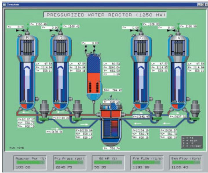
ли САЕ. Устройства включают полную нейтронную и термогидравлическую модель реактора и его систем охлаждения. Для получения реалистичной картины реагирования имитируются интерфейсы с соседними системами. В устройствах применяется удобный для пользователя интерфейс человек–машина на графической основе для ввода различных данных, имитации отказов и демонстрации поведения систем.
