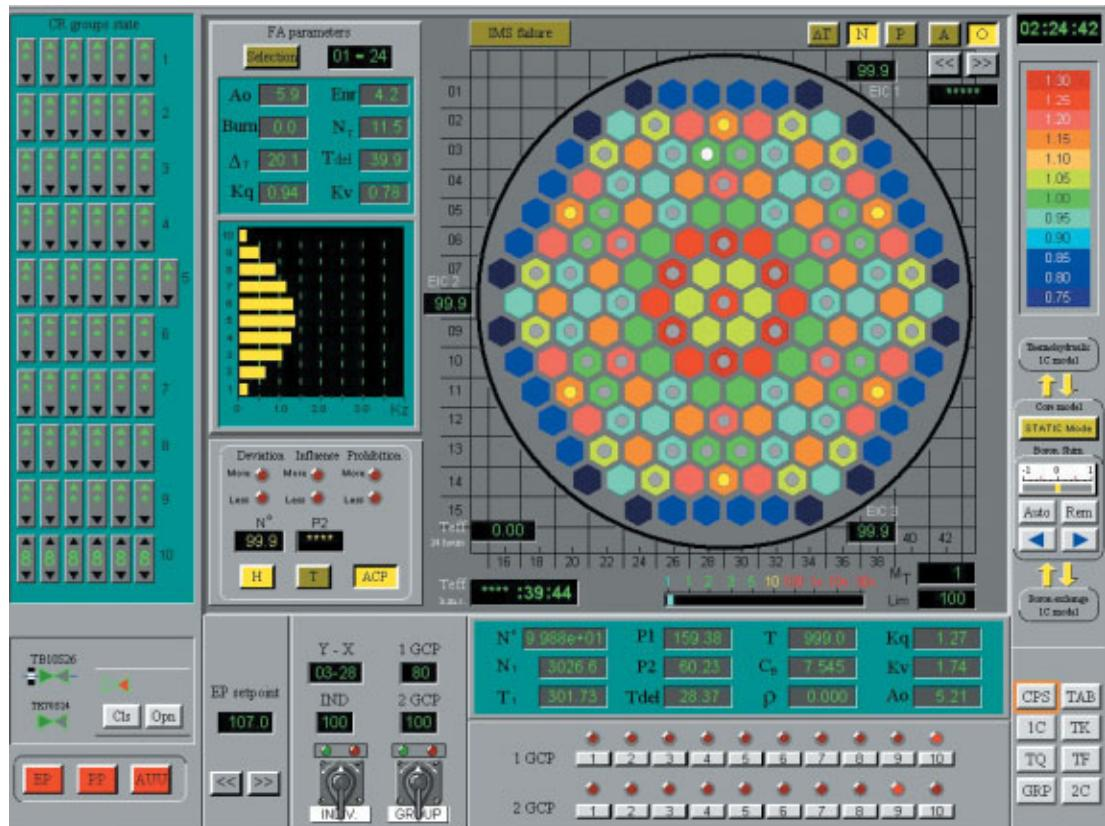
теплопередачи и системы контроля давления и суммарного количества теплоносителя показаны как единый контур. Четыре парогенератора моделируются по отдельности. Для контроля реактивности имеется специальный экран, на котором показаны диаграммы контроля пределов активности и состояние трех устройств контроля активности, управляемых системой регулирования работы реактора.
