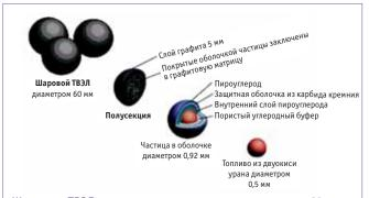
Шаровые ТВЭЛы уранового топлива имеют диаметр 60 мм— немного меньше теннисного мяча. Справа расположены покрытые оболочкой частицы диаметром около 1 мм. Частица в оболочке состоит из ядра— двуокиси урана, покрытого четырьмя слоями оболочки.
