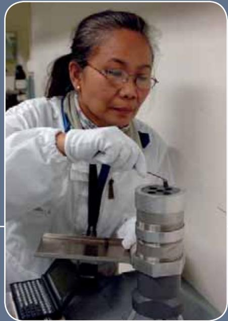
**11** Un inspecteur vérifie l'enrichissement de la pastille à l'aide d'un instrument appelé analyseur multicanal, qui est raccordé à un ordinateur de poche.
