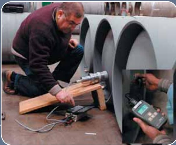
**5** Vérifier le cylindre, c'est une chose. Vérifier l'intérieur, c'en est une autre. Les inspecteurs utilisent des instruments perfectionnés tels que des détecteurs de germanium et de l'iodure de sodium – comme ici – pour détecter les niveaux d'enrichissement, car la plupart des matières enrichies émettent des rayons gamma. Ces outils aident les inspecteurs à vérifier l'exactitude des registres.
