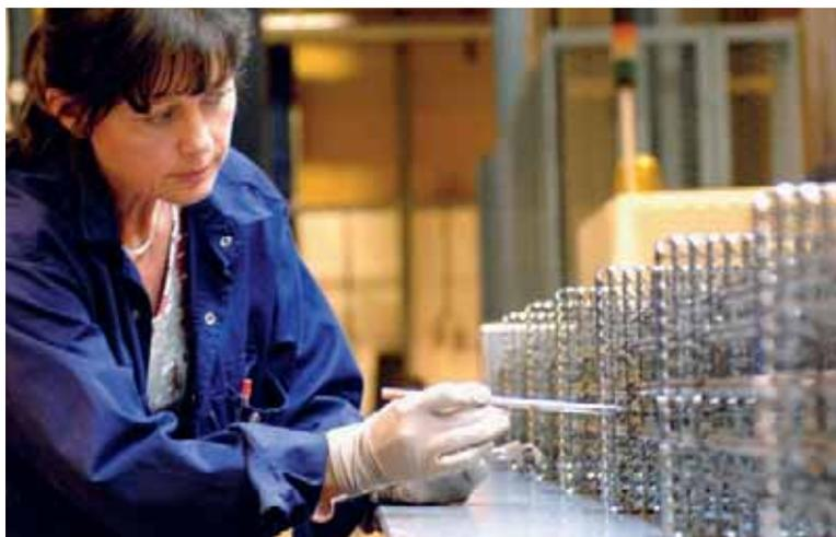
**On recherche de nouveaux moyens de sécuriser le cycle du combustible nucléaire. Ici, un technicien vérifie des tiges de combustible en phase d'assemblage terminal.**
