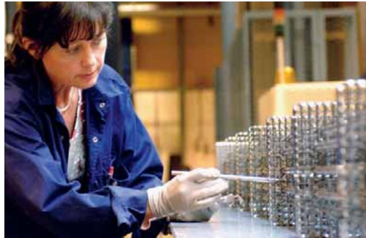
**Альтернативные инициативы по обеспечению безопасности ядерного топливного цикла вновь обрели актуальность. Здесь, на одном из заключительных этапов сборки твэлов, техник проверяет ядерные топливные стержни.** Фотография: Дин Калма
