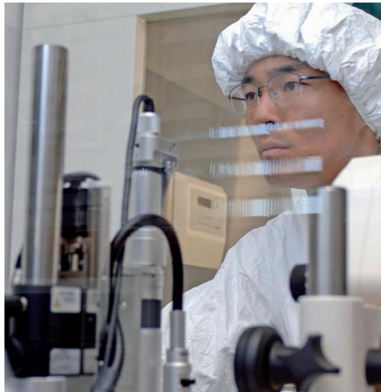
**Отбор проб окружающей среды стал краеугольным камнем международных гарантий. На снимке: техник в чистой лаборатории МАГАТЭ по гарантиям в Зайберсдорфе, Австрия, исследует урановые частицы под оптическим микроскопом.**
