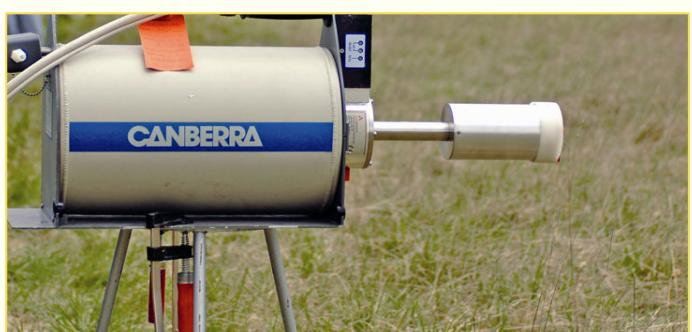
ولا تحتاج كل المعدات المستخدمة خلال التدريب إلى التبريد باستثناء النيتروجين السائل. فعلى سبيل المثال تعمل أجهزة قياس الطيف باستخدام بروميد اللانثيوم بطريقة مختلفة، حيث لا تحتاج البلورات إلى التبريد ولكن يجب أن تعمل في ظلام كامل. ولذلك يجب استخدام جراب أسود لتغطية البلورة كما نرى في الصورة.
