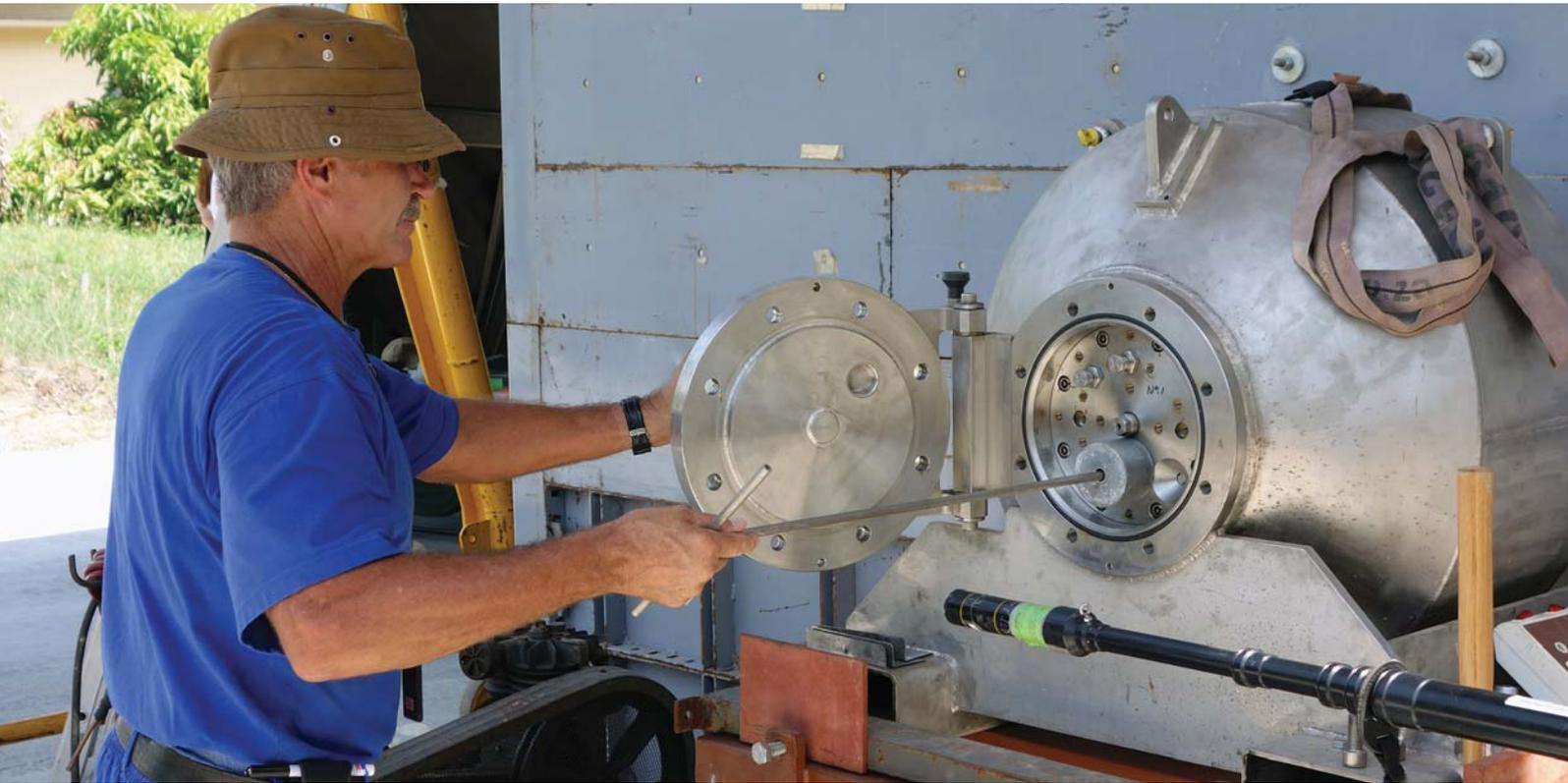
Les sources scellées sont glissées à travers un passage dans un dispositif blindé d'entreposage de longue durée. L'AIEA a fourni deux dispositifs de ce genre à la mission de Manille.
