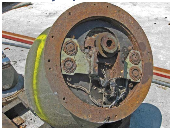
Проржавевший изъятый из употребления источник до кондиционирования.
