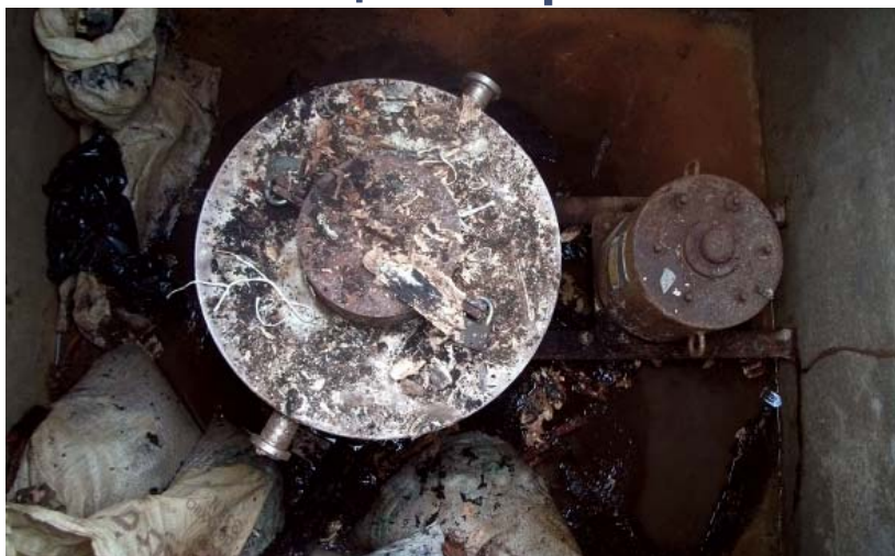
Изъятый из употребления источник в бункере для хранения.
